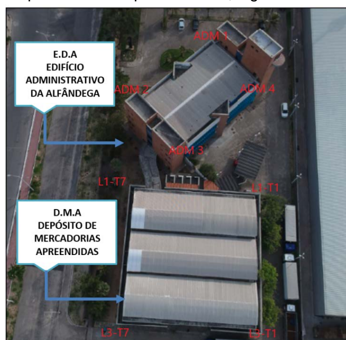
Galpão ALLFOR com indicações dos pontos de descida do SPDA
