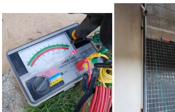
Medição de continuidade de descida do SPDA no ponto L1-T7.
