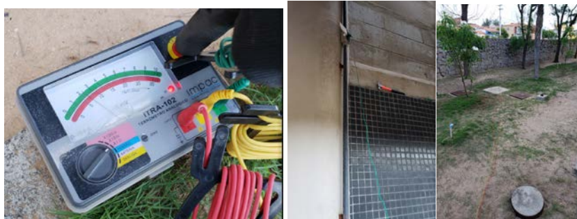
Medição de continuidade de descida do SPDA no ponto L1-T7.
