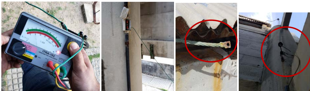
Medição de continuidade de descida do SPDA no ponto L1-T1 (ISOLAMENTO QUEBRADO E DESCIDA DESCONECTADA DO CAPTOR0).
